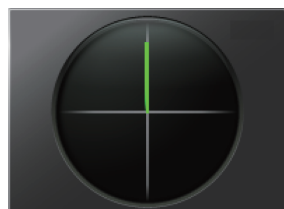
Señal de la portadora sin modular
