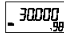
La frecuencia del canal de memoria se mostrada mientras dura la selección.
